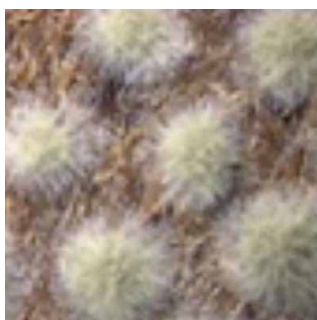
Développement de moisissures grandissement x50
